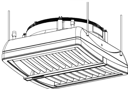
Комплект поставки кронштейна включает в себя: **ONE**-кронштейн, 2 втулки 12x1x44, 2 болта М8-75, шайбы; **CR**-кронштейн, 2 втулки 12x1x20 или 12x1x25, 2 болта М8-55, шайбы; **CR PRO**-кронштейн, 2 втулки 12x1x28 2 болта М8-60 либо 2 втулки 12x1x25 2 болта М8-55, 2 болта (М8-55), шайбы. Для установки консоли просверлите 2 отверстия диам.12-13мм в задней стенке как показано на рисунке. Специальные указатели в месте сверления отверстий указаны на корпусе агрегата.
