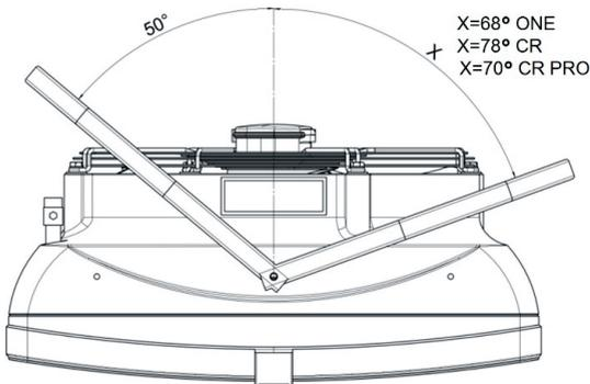
Тепловентилятор может поворачиваться относительно монтажного кронштейна в горизонтальной плоскости. Чтобы сделать это, необходимо смонтировать агрегат и подсоединить к гибкой подводке. В этом случае максимальный угол поворота по отношению к консоли в горизонтальной плоскости составляет **70°** для CR PRO, **78°** для CR1, CR2, CR3, **68°** для CR ONE в противоположную от патрубков сторону и 50° в сторону патрубков.
